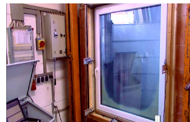
Die Temperaturwechselbelastung zeigt, ob auf das Abdichtungssystem Sommer wie Winter Verlass ist
