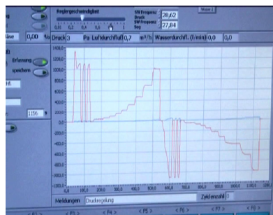
Um die dauerhafte Funktionsfähigkeit des Abdichtungssystems zu prüfen, wurden die Schlagregenprüfung und die Luftdichtheitsprüfung zuerst im Neuzustand und dann nochmals nach den Belastungstests durchgeführt.
