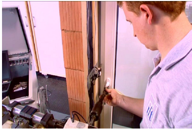
Bei der Dauerfunktionsprüfung muss das Abdichtungssystem seine Funktionsfähigkeit nach Stossbelastungen beweisen.
